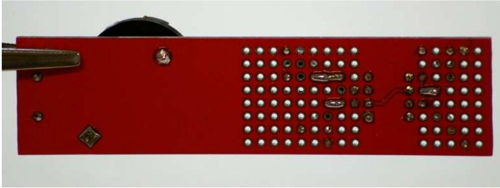
**Abbildung 11:** Verbindungen die durch Fluten mit Lötzinn entstehen
